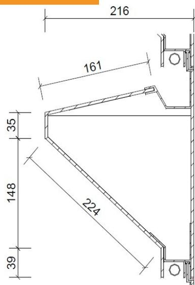
**TIPO DE ESTRUCTURA DE SOPORTE:** Armadura metálica primaria complementando a una estructura metálica, una estructura en madera o directamente sobre estructura de hormigón.
